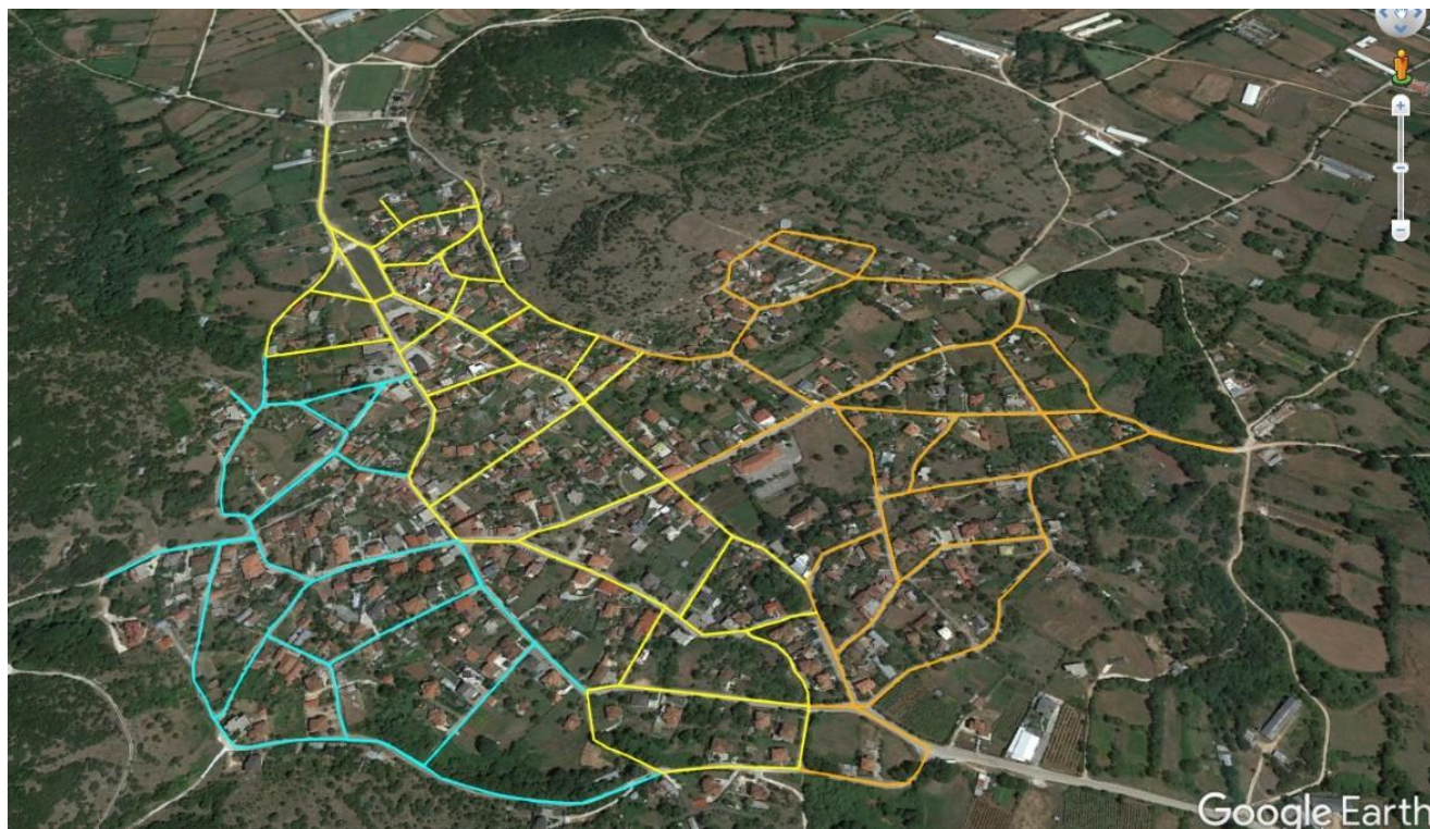
Εικόνα 4: Οριζοντιογραφία κεντρικού αγωγού Οικισμού «Ροδοτόπι».
